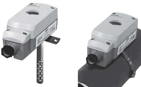
Термостаты защиты от замерзания предназначены для сигнализации при уменьшении температуры воды в обратном трубопроводе ниже +5°C. При этом вентиляторы завесы должны быть выключены, для чего необходимо подключать завесу через контакты термостата.
