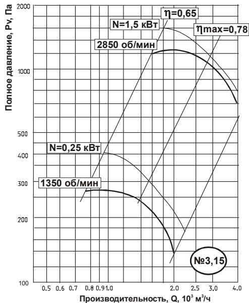
Рисунок 5. Аэродинамические характеристики вентиляторов ВЦ 4-70-4
