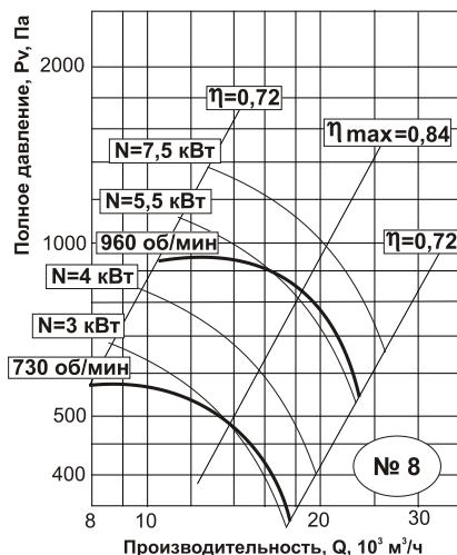
Рисунок 9. Аэродинамические характеристики вентиляторов ВЦ 4-70-10
